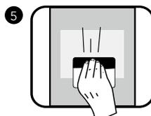
5 Stendere l'application tape in modo uniforme per evitare la formazione di bolle d'aria.
